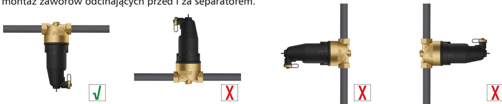
Rys. 5 Dopuszczalna pozycja montażowa separatora ADS 180 HP oraz 181 HP
